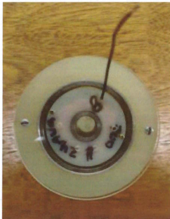
Figura 26. Eletroímã na parte superior do suporte da bancada de testes
